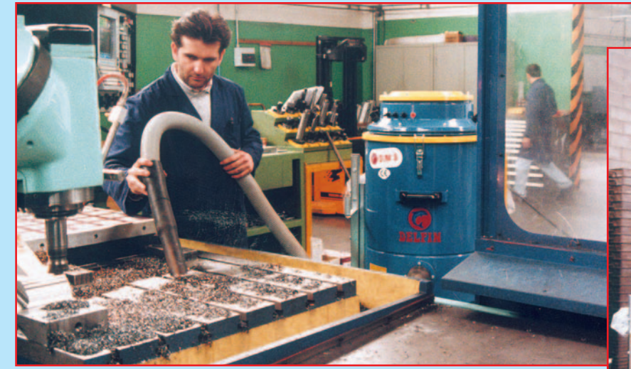
Aspirazione sfidri di lavorazione in azienda metalmeccanica. Aspiración chatarras de elaboración en empresa mecánica.
